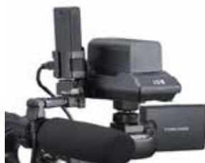
5GHz 帯の無線周波数を使った HD 映像および音声を送送する無線伝送装置
